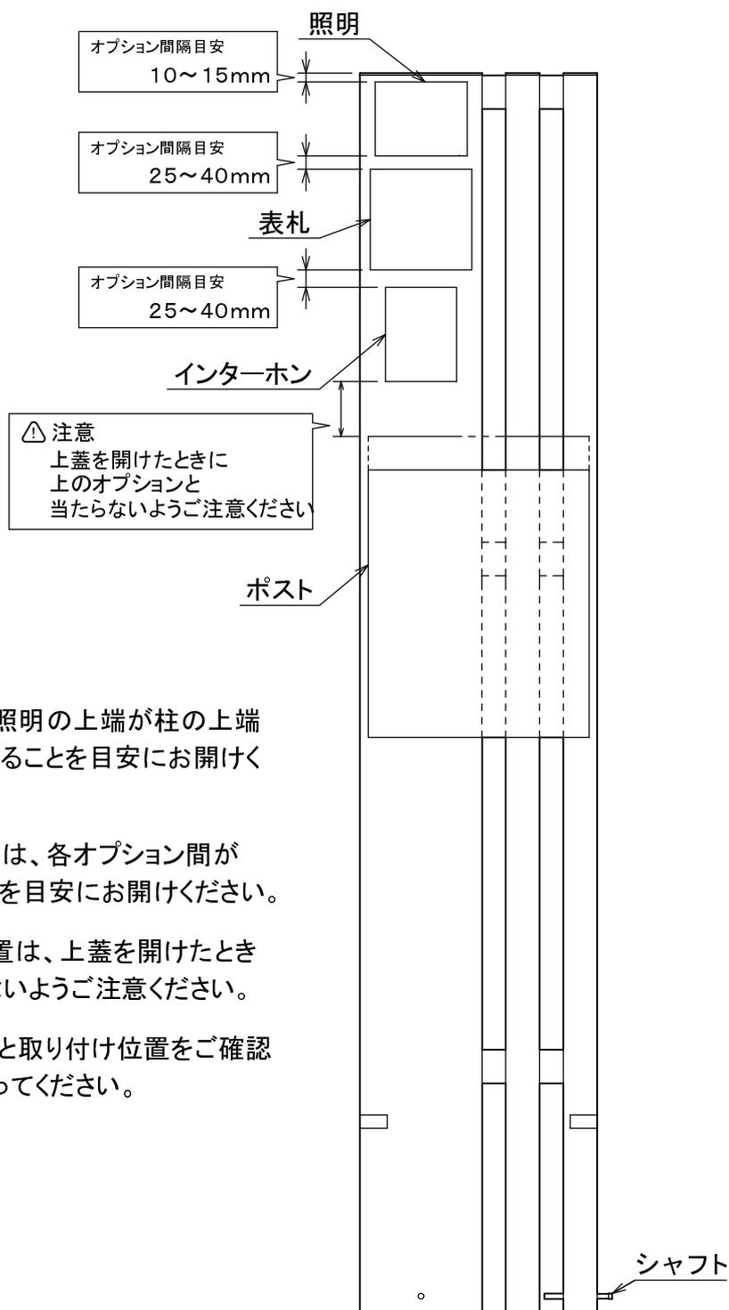
※ 照明の取付穴の位置は、照明の上端が柱の上端から10mm~15mmとなることを目安にお開けください。
