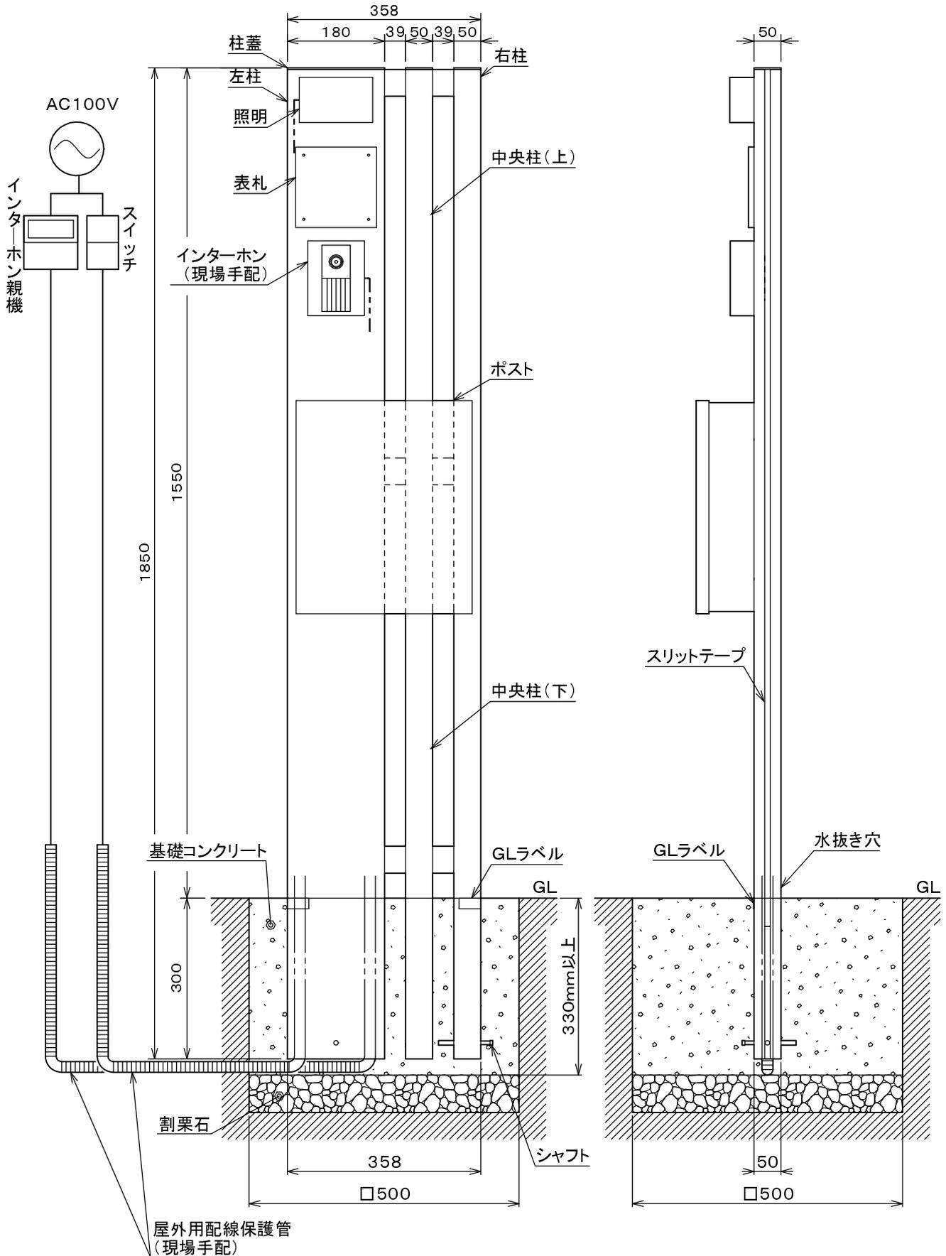
※上図の基礎の寸法は参考値です。施工現場の地盤強度によっては基礎の寸法を変更してください。
