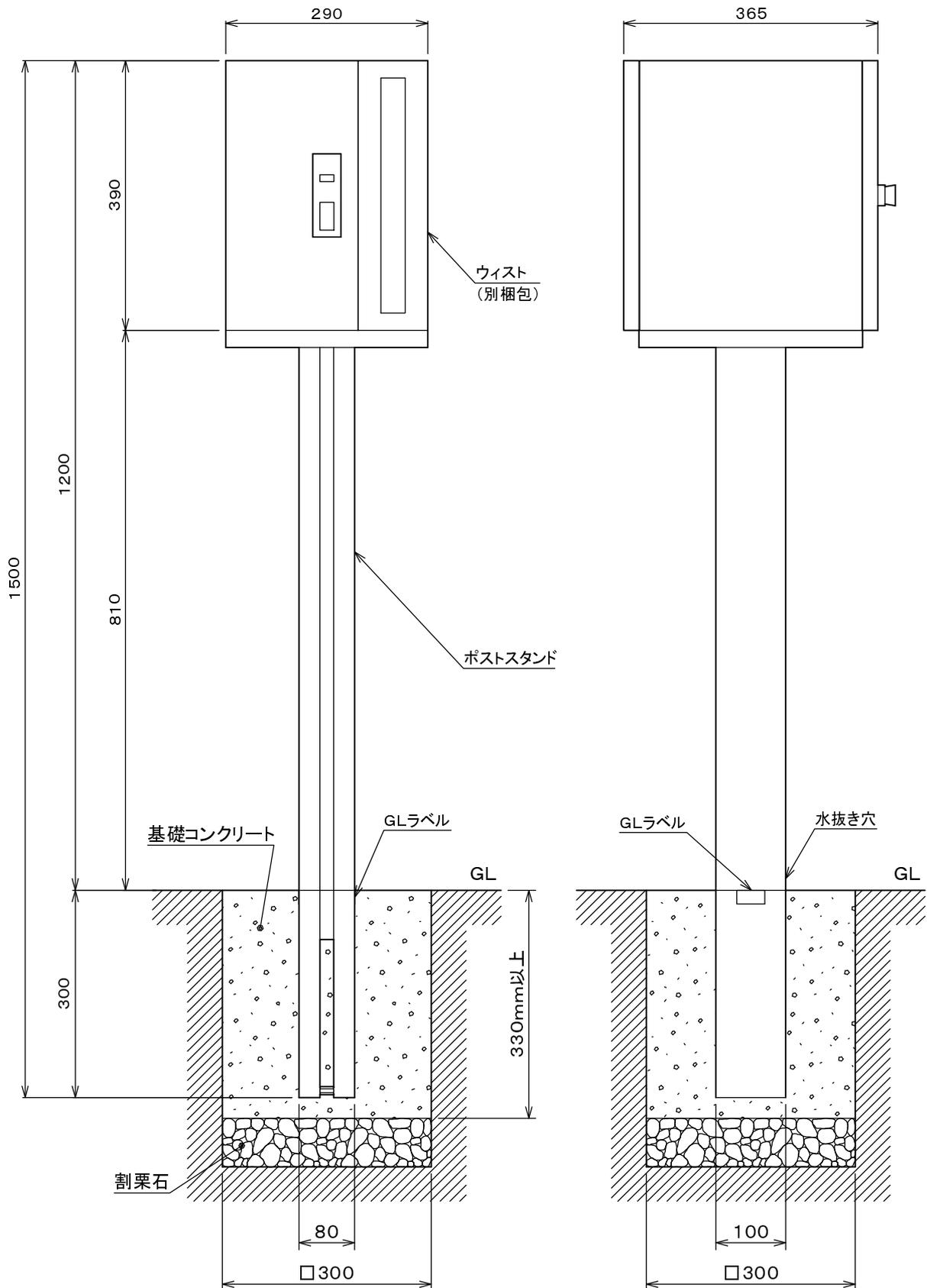
※上図の基礎の寸法は参考値です。施工現場の地盤強度によっては基礎の寸法を変更してください。
